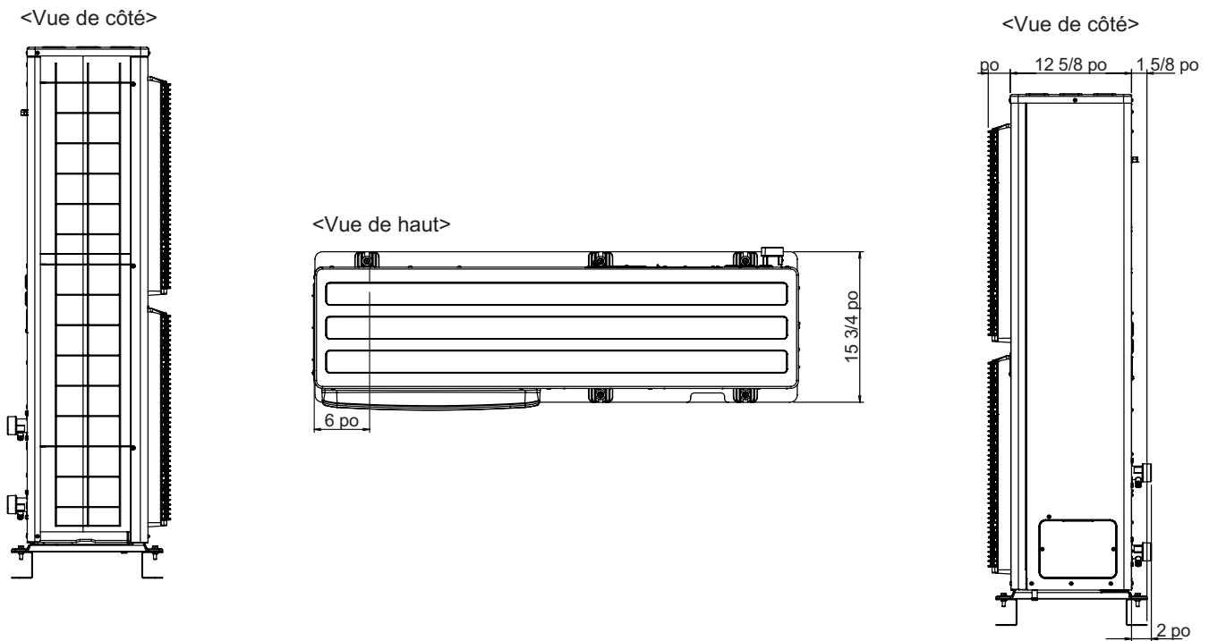
Figure 6-2 Dimensions de l'unité - Vue de dessus et de côté
